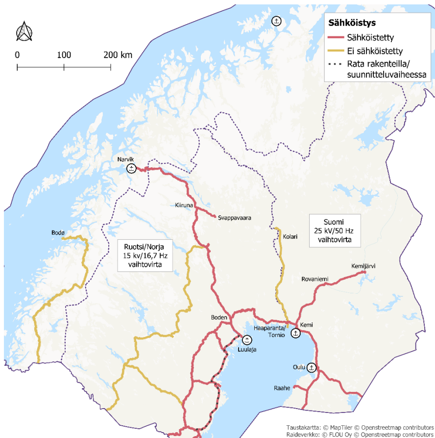
Kuva 14. Rataverkkojen sähköistys pohjoisessa Suomessa, Ruotsissa ja Norjassa.
