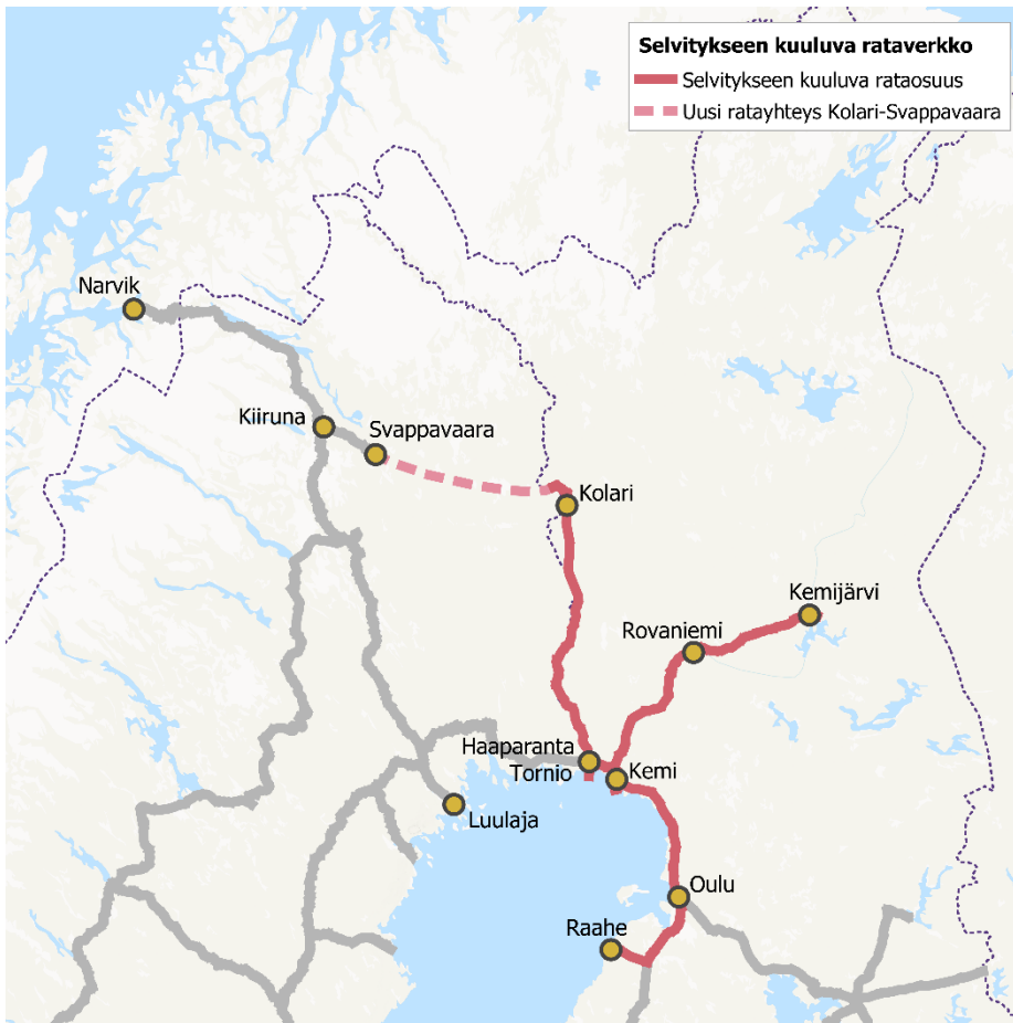
Kuva 4. Yhteysvälit, joille selvityskokonaisuudessa on tehty tekninen suunnitelma eurooppalaisen raidelevyden ratayhteyden toteuttamisesta (ratatekniset tarkastelut, kustannusarviot ja Suomen puolella myös ratalinjaustarkastelut).
