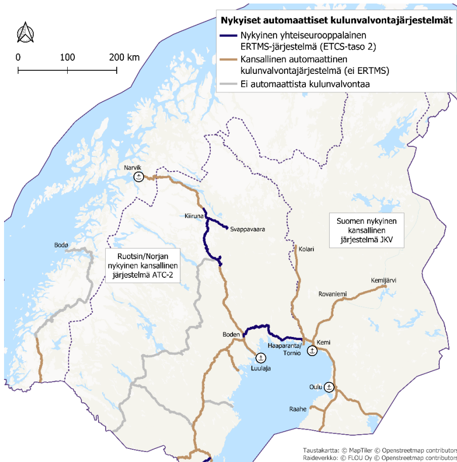
Kuva 15. Nykyiset automaattiset kulunvalvontajärjestelmät pohjoisessa Suomessa, Ruotsissa ja Norjassa. Suomen kansallinen kulunvalvontajärjestelmä ei ole yhteensopiva Ruotsin ja Norjan järjestelmän kanssa.
