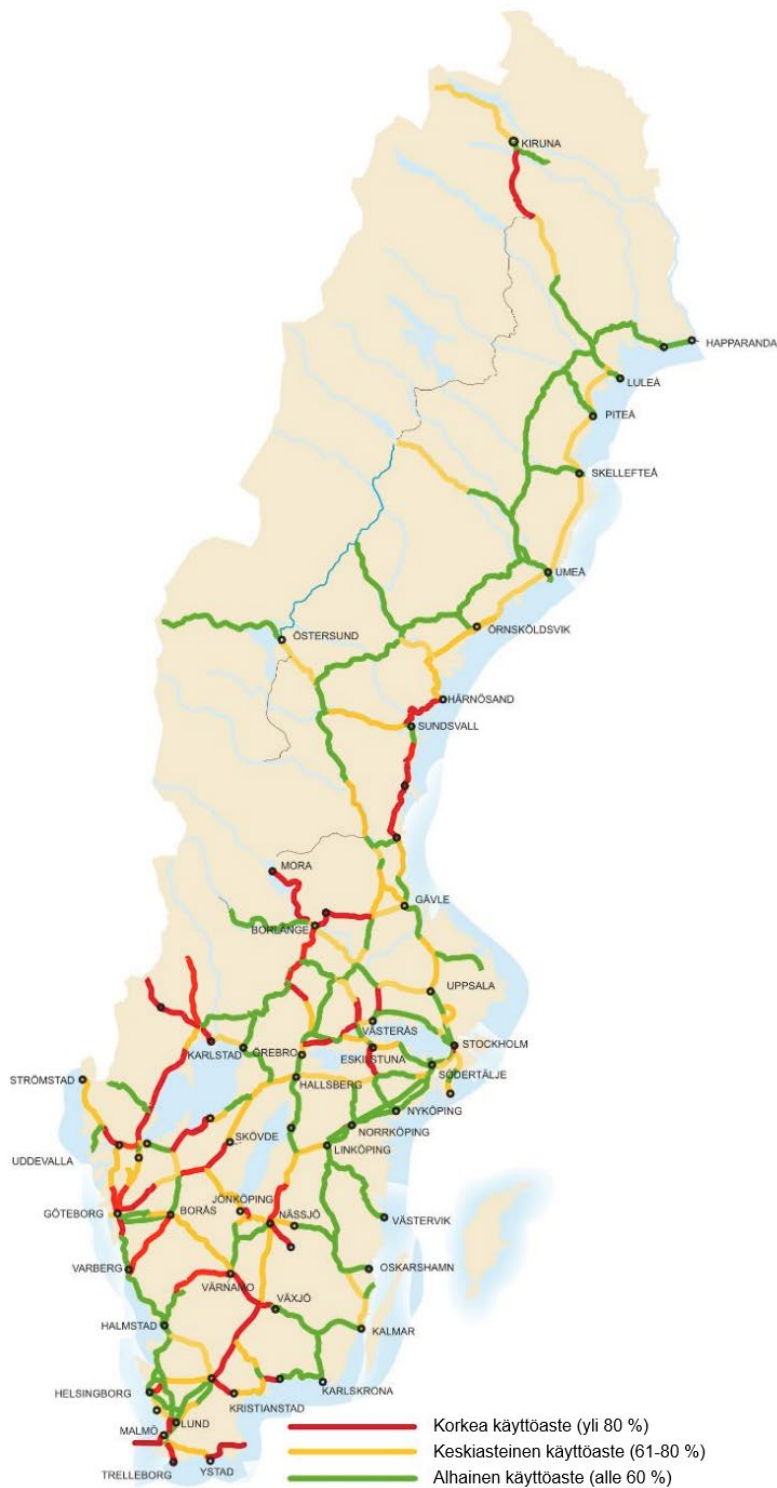
Kuva 11. Kapasiteetin käyttöasteen ennuste 2045-luvulla Ruotsissa (koko vuorokauden liikenne). Pohjois-Ruotsin Norrbotnia-rata on oletettu rakentuneeksi ennustevuoteen mennessä. (Trafikverket, 2024a).
