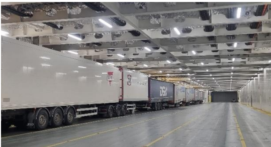
Kuva 2. Ro-ro-aluksissa ajoneuvojen ja trailereiden kuljettamiseen soveltuvia autokansia on usein useammassa kerroksessa ja lisäksi avoimessa tilassa aluksen ulkokannella. Suurimmissa säännöllisessä Suomen reittiliikenteessä olevissa aluksissa kaistametrejä on jopa yli 5 000. Kuva: Janne Kojo.
