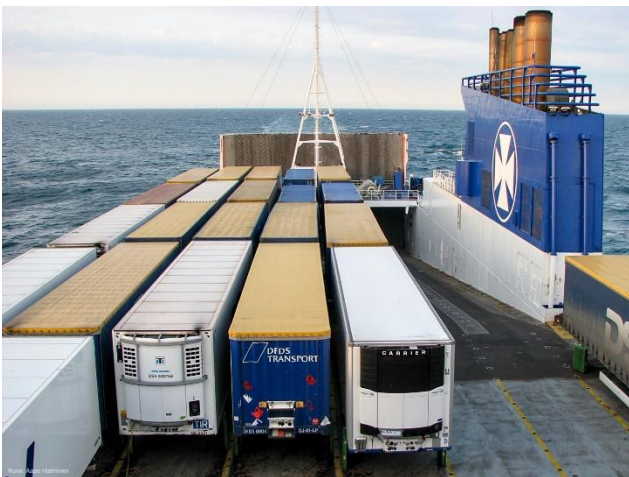
Kuva 23. Puoliperävaunuja lastattuna ro-ro-aluksen yläkannelle. Lastaus tapahtuu kuvassa oikealla ja takana näkyviä rampeja pitkin. Kuva: Aapo Halminen.
