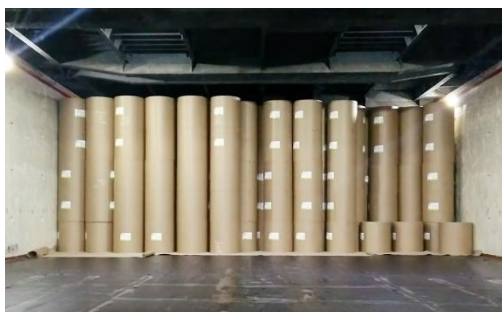
Kuva 17. Paperi- tai kartonkirullia sto-ro-aluksen ruumassa. Rullat on tuotu laivaan lavetilla vetämällä ja lastattu trukilla Atlantin ylitystä varten. Kuvassa lastaus on kesken. Kuva: Aapo Halminen.
