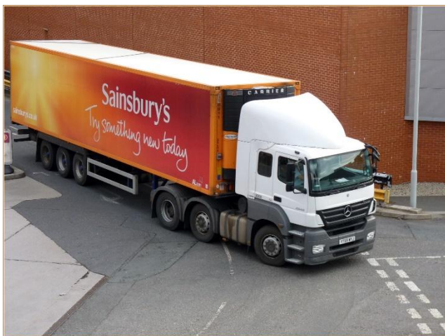
Kuva 9. Kansainvälisessä liikenteessä tyypillinen puoliperävaunun ja vetoauton yhdistelmä. Kuvan perävaunussa on jäähdytyslaitteisto asennettuna elintarvikkeiden kuljettamista varten. Kuva: Graham Richardson (CC BY 2.0 / Wikimedia Commons).
