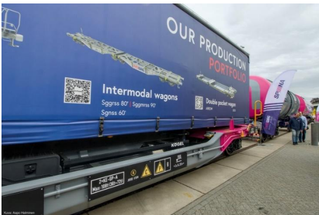
Kuva 10. Puoliperävaunu yhdistettyihin kuljetuksiin tarkoitettun erikoisvaunun päällä. Kuva: Aapo Halminen.
