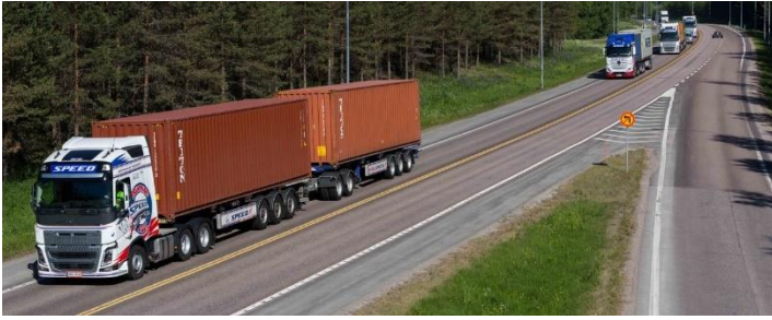
Kuva 8. HCT-yhdistelmä kuljettamassa kahta 40-jalkaista merikonttia. Kuvassa taaempana "tavallisia" kuorma-autoja. (Lahti 2019)
