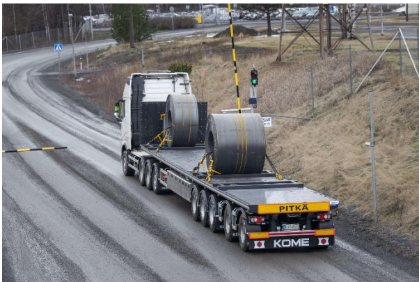
Kuva 19. Esimerkki erityisesti metallikelojen kuljetukseen tarkoitettusta tavallista suuremmasta ajoneuvoyhdistelmästä. Vaikka lavalla on näennäisesti runsaasti tilaa, on yhdistelmä hyvin raskaassa 71 bruttotonnin kuormassa (vrt. lain maksimi 76 tonnia). Kuva: Juho Kuva / VR Transpoint.
