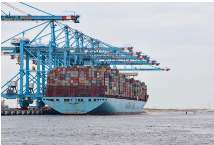
Kuva 3. Valtameriliikenteessä käytetty konttialus Rotterdamin satamassa. Kuvan laivan kapasiteetti on n. 18 000 TEUta. Kuva: Aapo Halminen.
