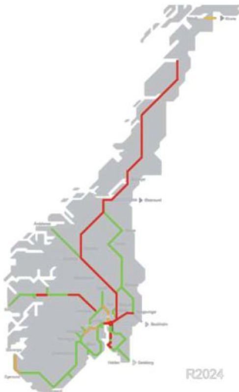
Kuva 46. Norjan rataverkon kapasiteetti vuorokauden aikana. Kuvassa punainen viittaa ylikuormitukseen päivätasolla, keltainen osittaiseen ylikuormitukseen päivätasolla ja vihreä siihen, että kapasiteettiä on tarjolla läpi vuorokauden. (Kongelige Samferdselsdepartement, Det 2024)
