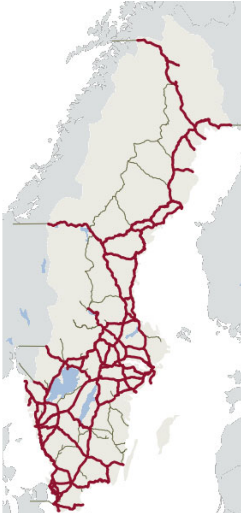
Kuva 4. Sähköistetyt rataosat Ruotsissa. (lähde: Järnvägsnätsbeskrivning 2020, https://jnbkarta.trafikverket.se/?year=2020 )
