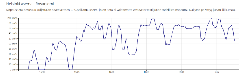
Kuva 17. Esimerkkinä Helsinki-Tampere IC27-junan (klo 15.24-16.56) nopeusprofiili 3.4.2019 (Julia junaliikenteen havaintojärjestelmä).
